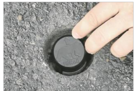
Un capteur HiKoB intégré sur dans la chaussée
