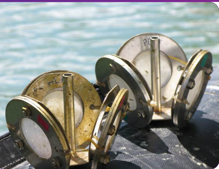
POCIS, échantillonneur passif pour les polluants hydrophiles © Irstea
